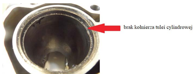
Rysunek 8 Tuleja cylindrowa z brakującym kołnierzem
