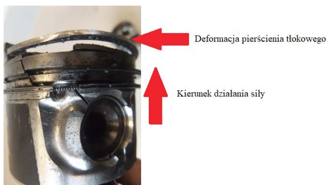
Rysunek 5 Tłok ze zdeformowanym górnym pierścieniem
