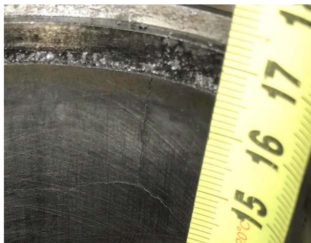
Rysunek 9 Pęknięcie tulei cylindrowej
