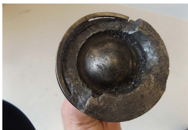
Rysunek 4 Powierzchnia denka tłoka ( widoczne są liczne ubytki w powierzchni)
