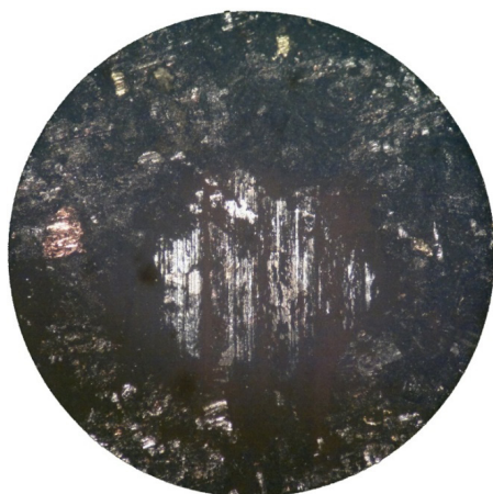
Rysunek 6 Zdjęcie mikroskopowe jednego z kraterów powstałego podczas badań
