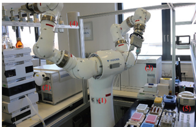
Rysunek 5 Robot dwuramienny CSDA10F (1) podnoszący pipetę, (2) LC/MS, (3) GC/MS, (4) półka z pipetami, (5) stanowisko przygotowywania próbek przed przeniesieniem ich do przyrządu analitycznego [19]
