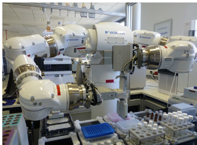
Rysunek 6 Robot dwuramienny SDA10F podczas pipetowania za pomocą ręcznej pipety wielokanałowej [20]
